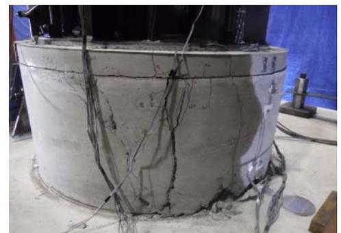
写真-2  $-5\delta_v$  到達時の損傷状況
