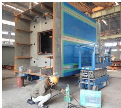
写真-1 発泡漏れ試験の状況
