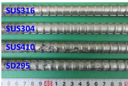
※SUS410, SD295：明確な断面欠損あり
