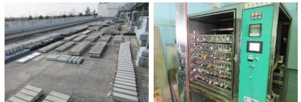
(A)暴露試験 (B)促進試験
