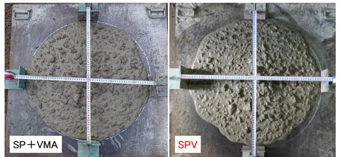
写真-2 スランプフロー試験時の試料の状況
