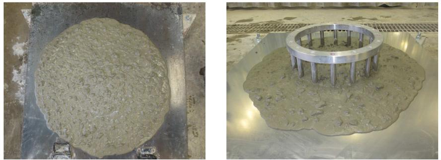
写真-1 G=0 試験状況 (左: スランプフロー, 右: Jリングフロー)
