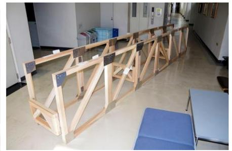
写真-3 木製折り畳み式トラス橋
