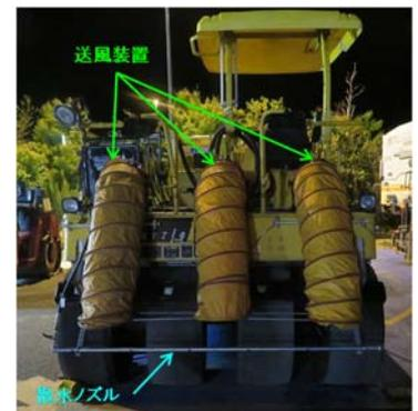
写真1 強制冷却装置
