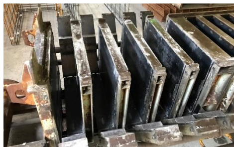
図-1 使用した型枠
