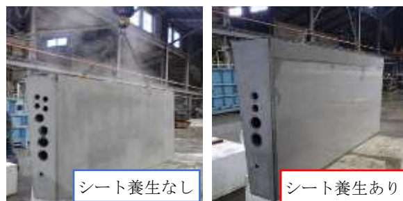
写真-1 試験体脱型状況
