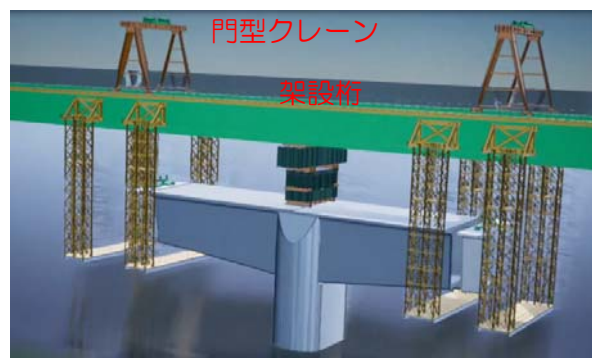
図-3 架設桁による張出し架設
