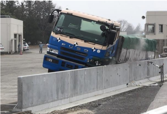
図 6. 実車衝突実験の状況
