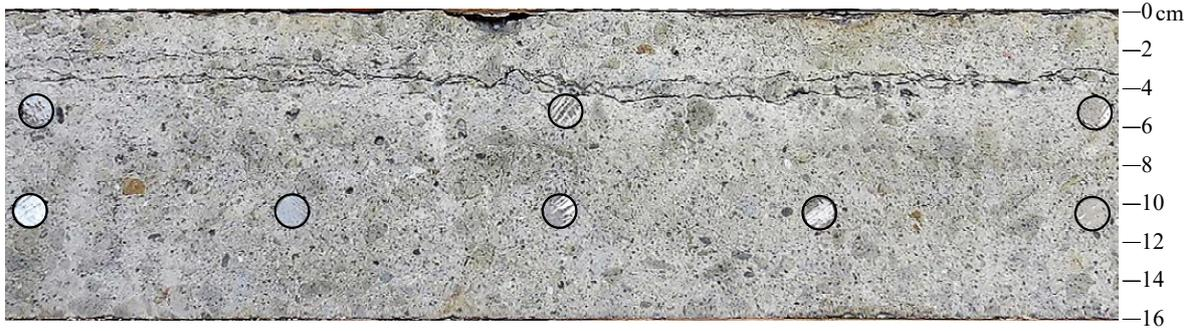
写真-2 凍結融解作用によりスラブ内部に生じた水平ひび割れ
