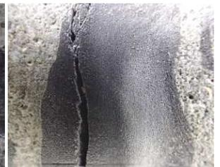
写真 4 粗骨材の割れ
