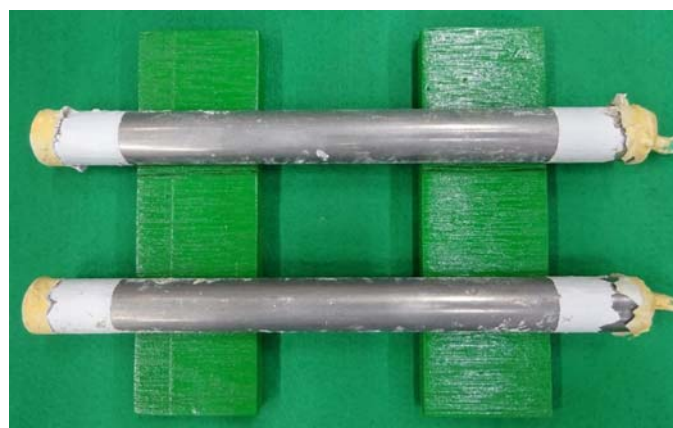
図6 鉄筋の腐食状況(塩無)
