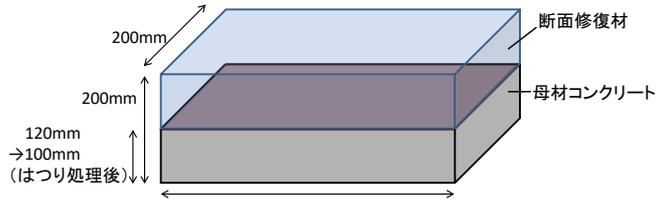
図-1 コンクリート供試体
