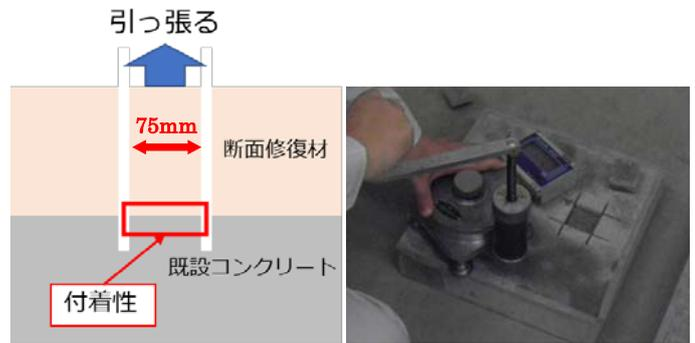
図-3 引張強度試験概要図
