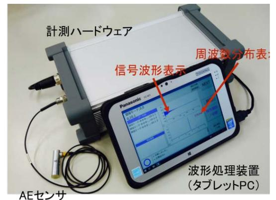
図1 AE センサを用いた打音検査装置
