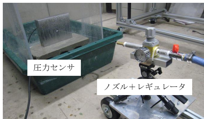
図4 1mm 径ノズルを用いた加振力測定試験
