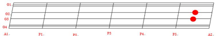
図4 橋梁 B の LDV 計測点
