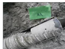
写真-2 充填が不十分な例
