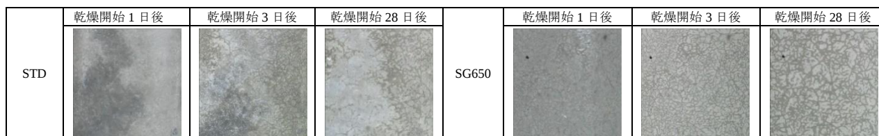
(A)乾燥開始からの経過による微細ひび割れ発生状況(STD, SG650)
