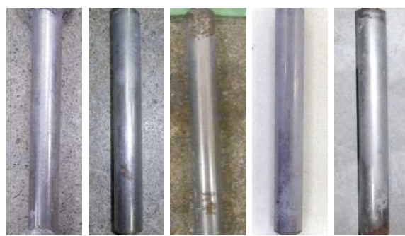
図-6 鉛直方向配置鋼材の腐食状況 (実験②)
