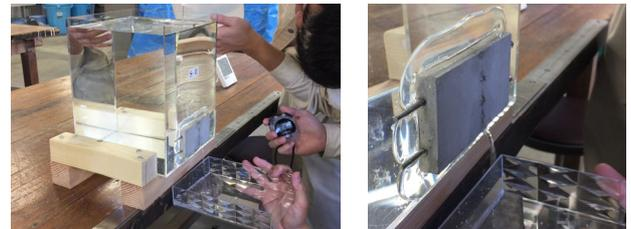
写真-2 水の流出量測定状況
