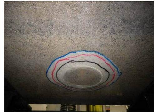
写真1 押し抜き試験状況
