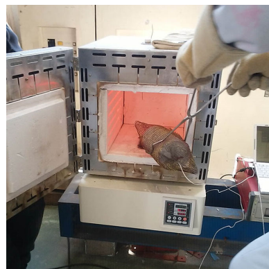
図-1 電気炉への投入状況
