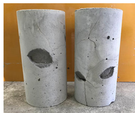
図-3 爆裂後の P6-PVA0 供試体
