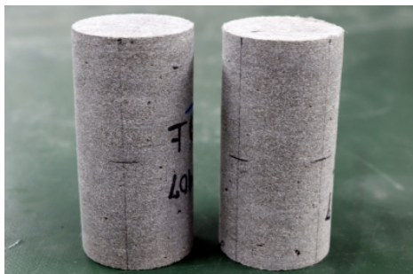
図-3 プリント造形物からコア抜きした供試体の外観
