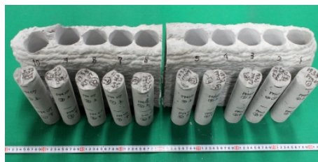
図-2 壁形状の造形物とコア抜き位置
