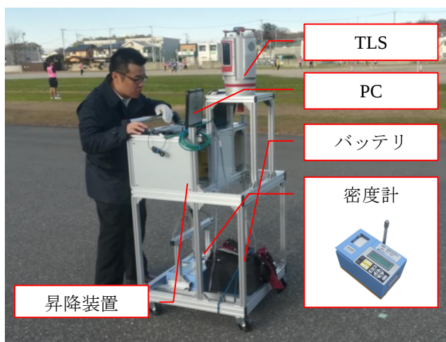
図-1 計測台車への機器取り付け状況
