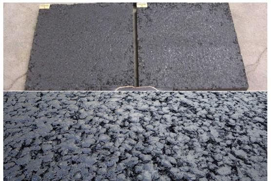
写真-1 室内供試体の表面 (上) と試験施工後の路面 (下) の様子
