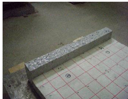
写真-4 断面写真 ( t=50\text{mm} ；鋼繊維位置 25mm)
