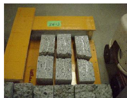
写真-5 断面写真 ( t=90\text{mm} ；鋼繊維位置 45mm)
