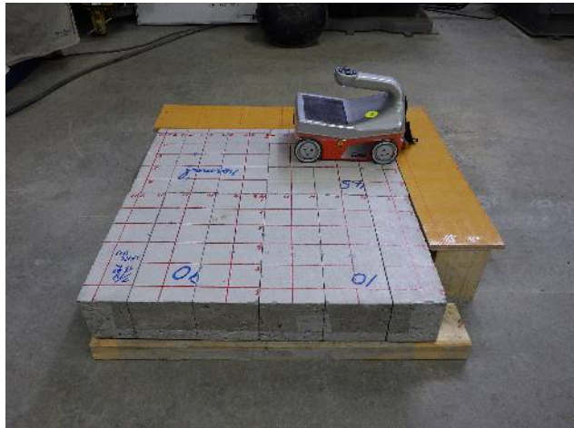
写真-2 測定状況（90mm 下部鉄板なし）
