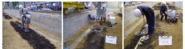
図-1 左：供試体作製，中：平板載荷試験，右：小型 FWD 試験
