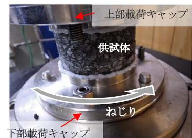
写真-1 載荷ユニットへの供試体設置状況
