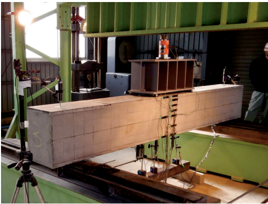
写真 1 供試体載荷試験状況
