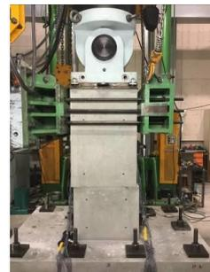
図-7 供試体 No. 2 基部ひび割れ時
