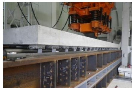
写真-2 輪荷重走行試験の様子 (切り出し供試体)
