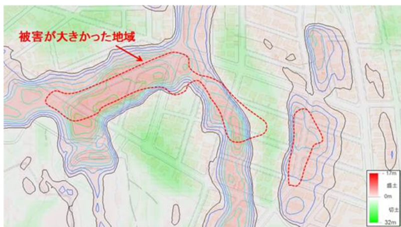
図-1 被災地と盛土の関係図 (清田)
