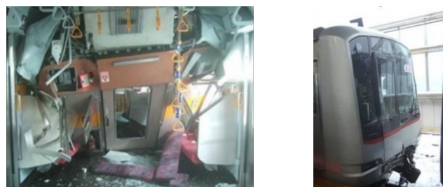
先頭車客室内後方 先頭車前面 図-2 東急東横線脱線衝突事故の様子 (2014年2月15日)
