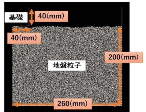
図2 DEM解析の地盤モデル
