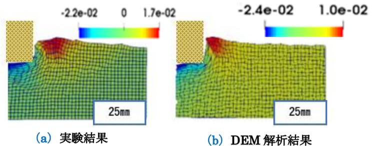
図4 地盤内部の鉛直変位分布 (25mm 沈下)
