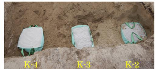
写真2: 地盤内にゆるみ部を設置
