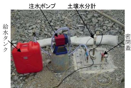
写真-1 原位置不飽和透水試験の測定状況
