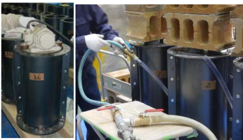
写真-1 供試体の作製・グラウトの注入状況 表-1 可塑状グラウトの配合表
