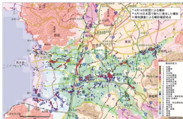
図-1 熊本平野の微地形区分と液状化発生地点 1)
