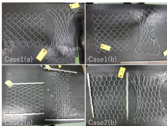
写真-2 試験後の変形性状（左：試験前，右：試験後）
