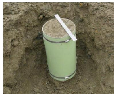
写真1 大型供試体(D/H=200mm/400mm)の採取
