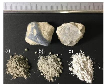
図-2 破碎コンクリート、固化材と不溶化材の概要; a)N, b)BB, c)Mg/Ca 不溶化材
