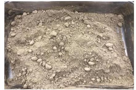
図4 目標含水比9%のバライト砕石混合土
