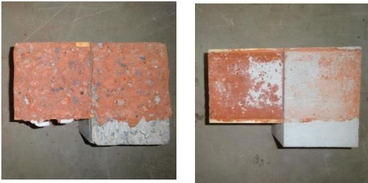
図-4 破断面の様子 (左：目粗し，右：コテ均し)
