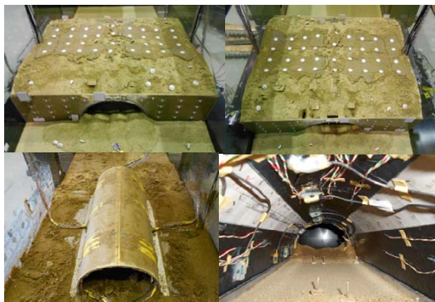
写真2 実験終了後の状況写真 (頂部・脚部を補強したケースのもの)
