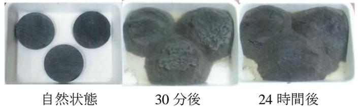
図3 浸水崩壊度試験結果
