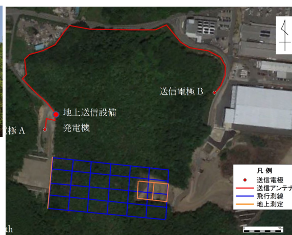
図-2 地上送信源配置と飛行測線
