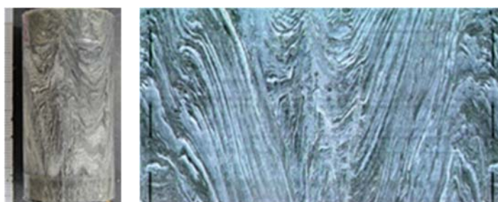
写真-3 泥質片岩の片理面と平行に採取した供試体と側面展開写真
