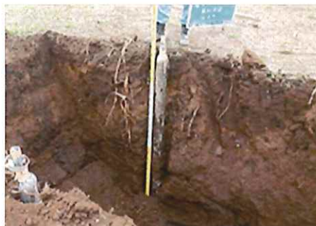
写真-1 地盤内に作製した改良体
